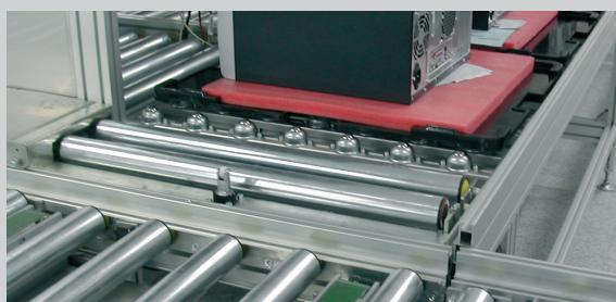
schnitte pro Antriebseinheit realisiert werden. Außerdem wird das Beschleunigungs- und Bremsverhalten der Anlage verbessert. Das erhöht die Positioniergenauigkeit und damit die Sicherheit, denn ein Kontakt von empfindlichen Gütern auf der Rollenbahn wird so vermieden. Kein Wunder, dass auch die Hersteller der Rollenbahnsysteme die Riemens von ContiTech empfehlen.
